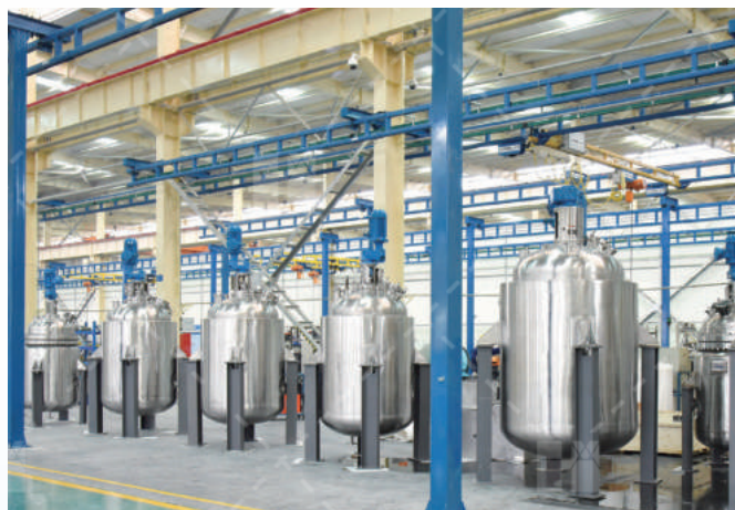
哈氏合金 (NS3304) 反应釜，应用于腐蚀反应工艺 Hastelloy (NS3304) reactor, mainly for corrosion reaction process
