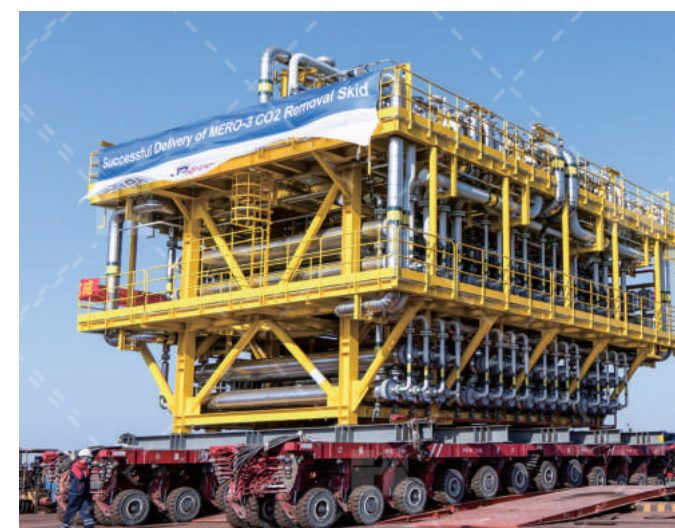
用于 MERO3 FPSO 上的CO 2 隔膜罐模块 CO 2 Membrane skid package for MERO3 FPSO
